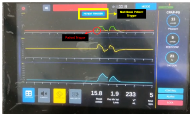
Fig. 4. Hasil uji coba mode SIMV dengan pressure trigger
