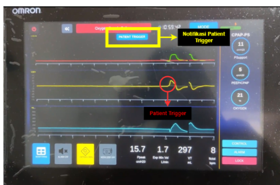
Fig. 7. Hasil uji coba mode CPAP dengan flow trigger
