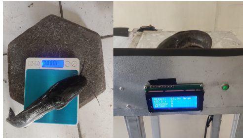
Fig. 7. Pengujian sensor loadcell
