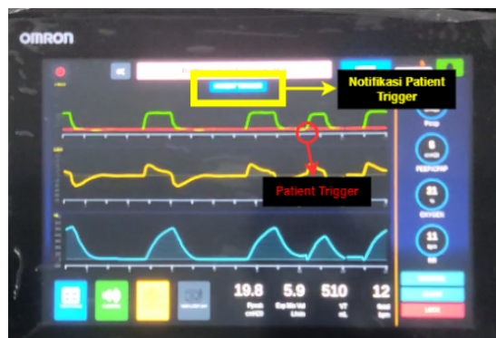
Fig. 6. Hasil uji coba mode CPAP dengan pressure trigger
