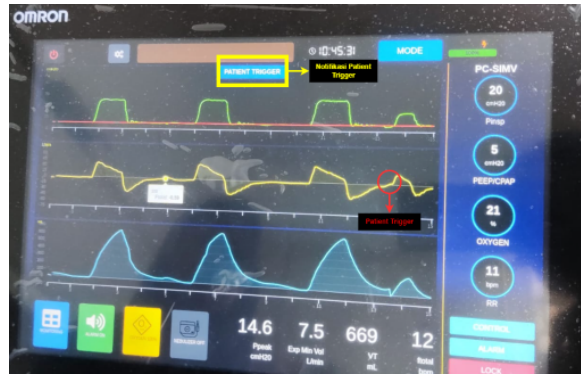
Fig. 5. Hasil uji coba mode SIMV dengan flow trigger
