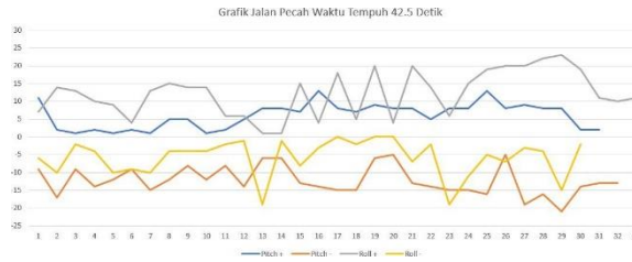
Fig. 11. Grafik pengujian sumbu pitch dan roll pada rintangan jalan pecah dengan waktu tempuh 42,5 detik
