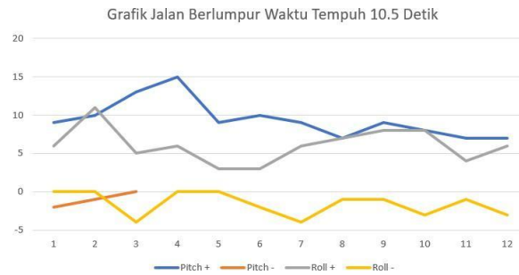
Fig. 26. Grafik pengujian sumbu pitch dan roll pada rintangan jalan berlumpur dengan waktu tempuh 10,5 detik
