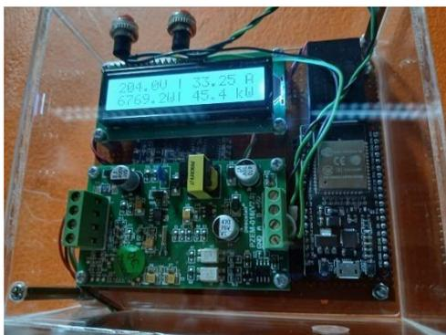
Gambar 2. Alat Power Monitor yang telah Terpasang
