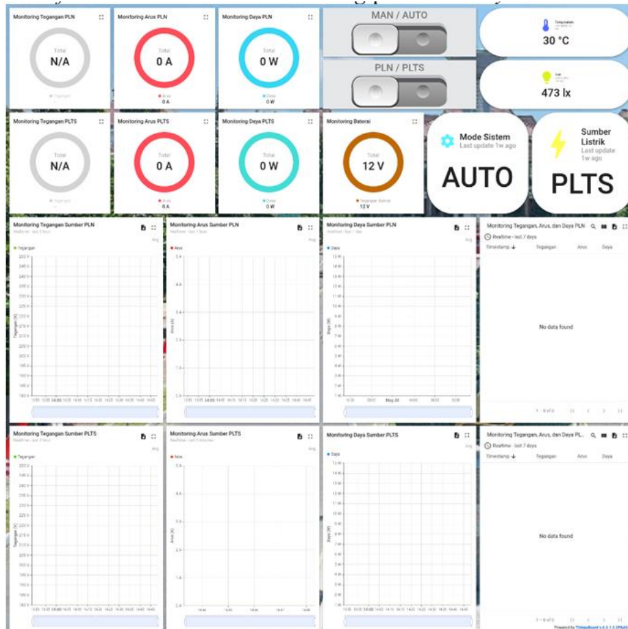
Gambar 4. Dashboard monitoring sistem ATS berbasis IoT menggunakan ThingsBoard .
