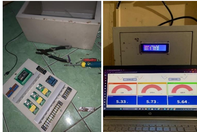
Fig. 5. Hasil Alat Sistem Monitoring Dan Kontrol Energi Listrik Berbasis IoT
