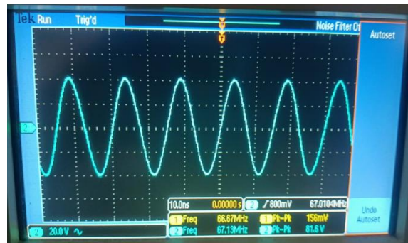
Fig. 18. Bentuk Gelombang Pengukuran Amplifier yang Terbaca Pada Osiloskop.
