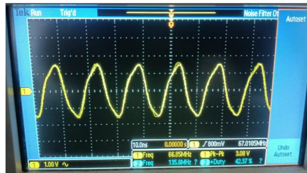
Fig. 13. Gambar 1. Bentuk Gelombang yang Dihasilkan Modul Si5351 Pada Frekuensi 67 MHz
