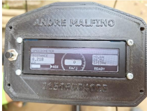
Fig. 7. Tampilan Antarmuka Visual Display OLED
