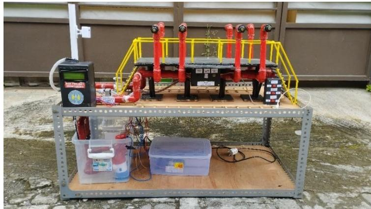
**Fig. 7.** Prototype Sistem Monitoring dan Pendeteksi Dini Kebakaran pada Sarana Filling Shed Rail Tank Wagon berbasis *Internet of Things*
