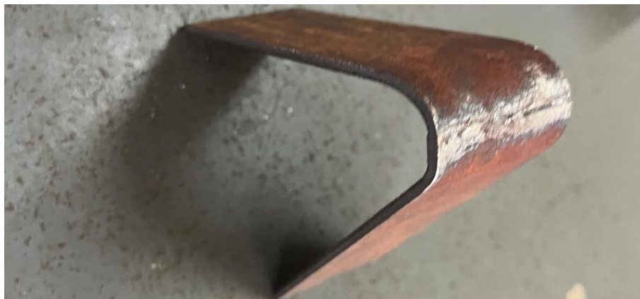
Gambar 5. Hasil pengujian spesimen uji lentur
