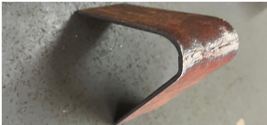
Gambar 5. Hasil pengujian spesimen uji lentur
