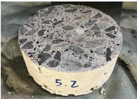
Gambar 7. Benda Uji Ketahanan Kejut Saat Retak Pertama
