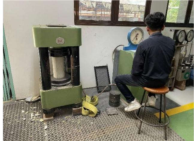
**Gambar 1.** Proses Pengujian Kuat Tekan Beton
