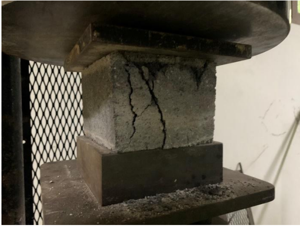
Gambar 4. Pengujian kuat tekan
