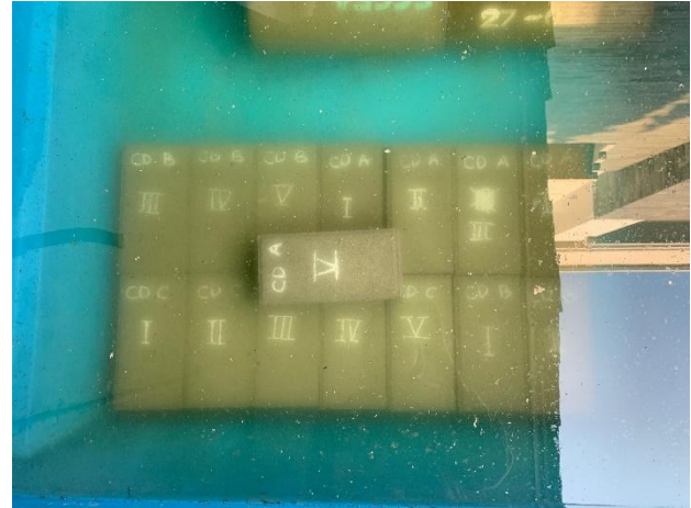
Gambar 9. Perendaman benda uji penyerapan air
