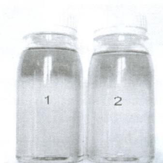
Gambar 4. Perbandingan antara bahan bakar minyak solar (1) dan biodiesel (2)
