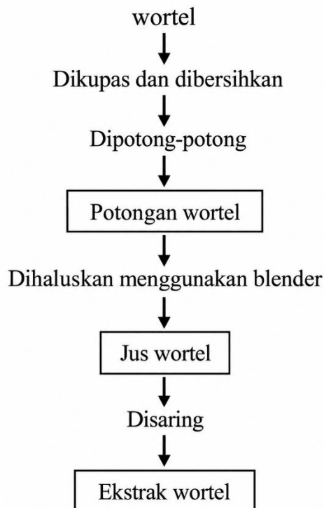
Gambar 1 Proses Pembuatan Ekstrak Wortel
