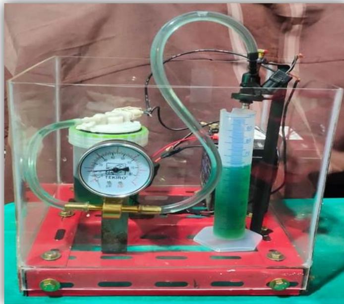
Gambar 4 Alat Pembersih Injector Sepeda Motor Portable
