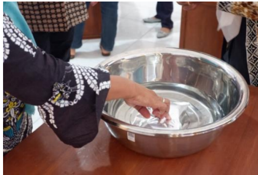
Gambar 4. Pelaksanaan uji kebocoran sederhana pada hasil sealing .
