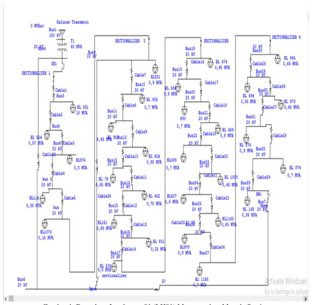
Gambar 1. Penyulang Lamhotma 01 (LH01) Menggunakan Metode Section
