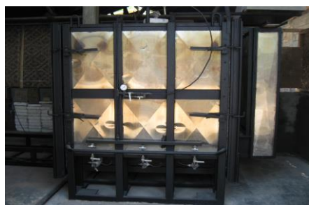
Gambar 4. Peralatan Pembakar Keramik untuk UKM “Burat Kriasta”
