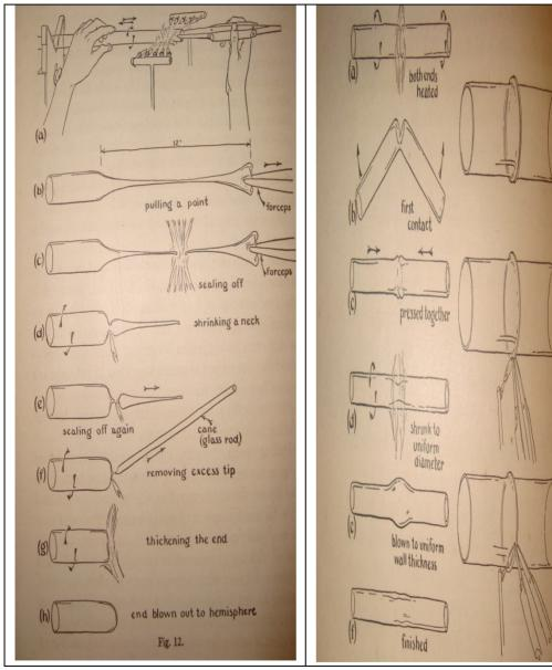
Gambar 2. Proses Pembuatan Tabung
