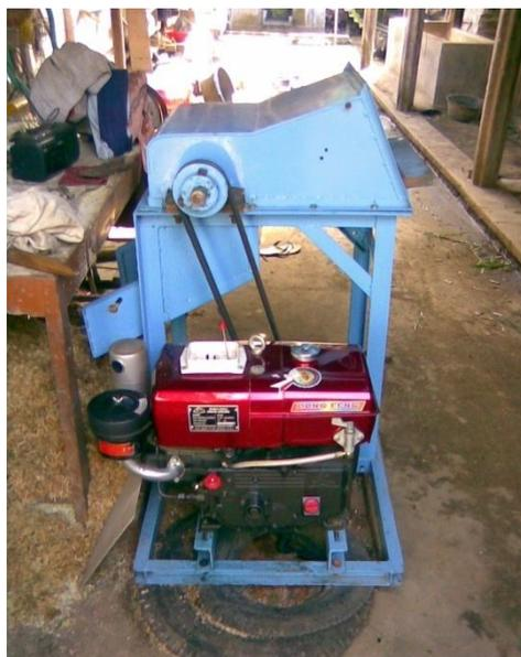
**Gambar 3. Foto Tampak Samping Mesin Pengolah Limbah Pertanian**
