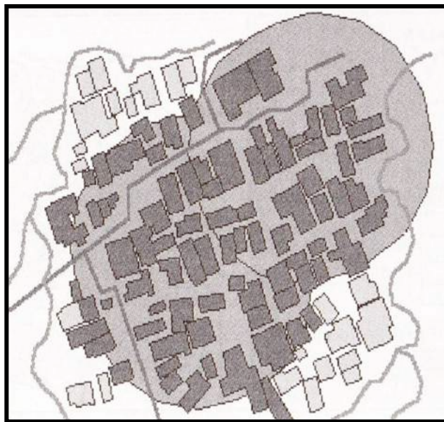
Gambar d. Analisa buffer dengan metode fitur intersection
