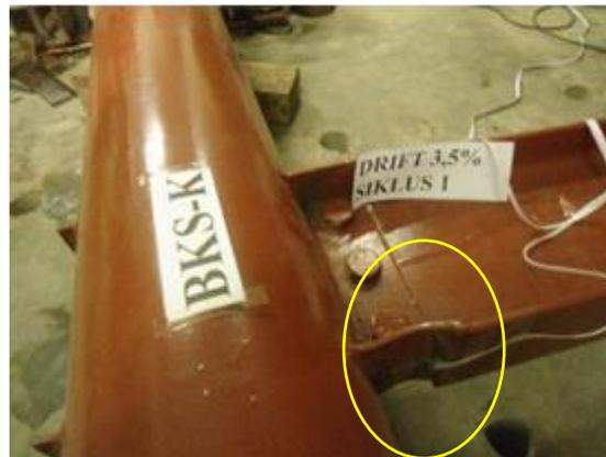
Gambar 17. Retak Pertama Kali Benda Uji BKS-K
