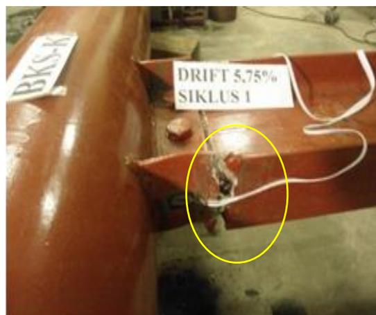
Gambar 18. Keruntuhan pada Benda Uji BKS-K
