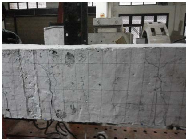
Gambar 15. Close up Pola Retak Benda Uji BLU
