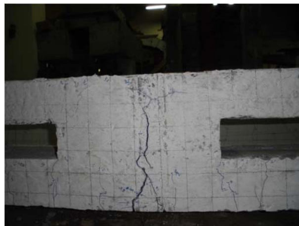
Gambar 16. Close up Pola Retak Benda Uji BLB
