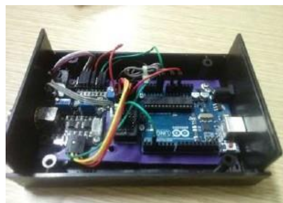
Gambar 2. Mikrokontroler Arduino Uno sebagai pusat pengolahan data sensor.
