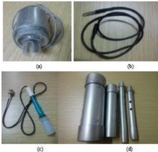
Gambar 1. (a) sensor kekeruhan termodifikasi, (b) sensor temperatur air, (c) sensor pH, (d) rumah sensor dan pelampung.
