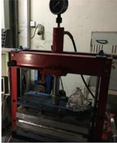
Gambar 2. Alat *hot press* pada pembuatan komposit
