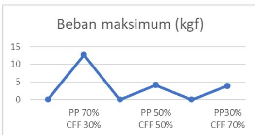
Gambar 5. Diagram beban maksimum uji tarik
