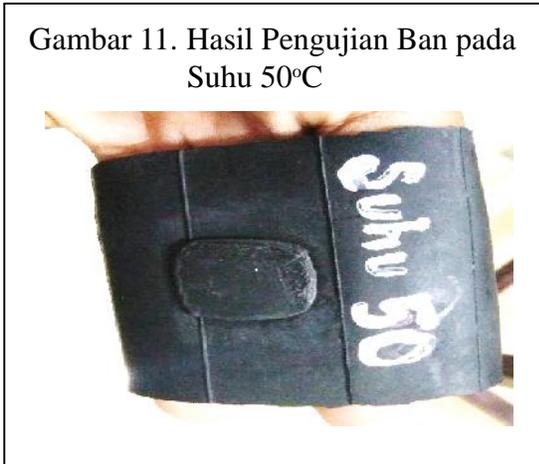
Sesuai hasil pengujian pada Gambar 11, menunjukkan bahwa suhu 50 °C belum termasuk suhu yang tepat dalam proses penambalan. Bahan penambalan telah terlihat menempel dengan ban, akan tetapi bahan masih belum menempel dengan kuat.
