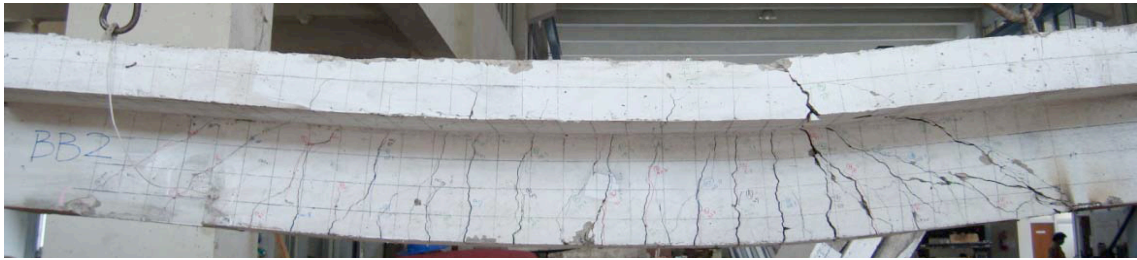
Gambar 8. Pola retak balok berlubang BB2 (Krasna, 2010)
