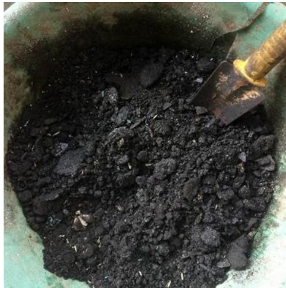
Gambar 2. Residu hasil pengolahan sampah plastik (Sumber: Dokumentasi Tia Sofiana, 2022)
