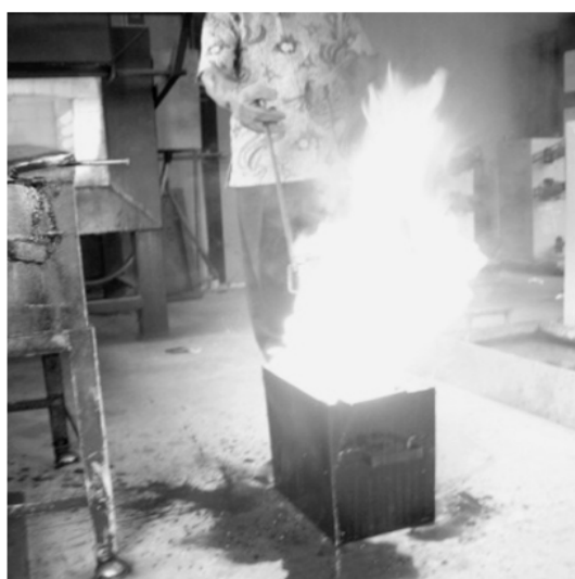
Gambar 5. Api yang Muncul Saat Pencelupan Pahat ke dalam Minyak Setelah Proses Karburising Padat
