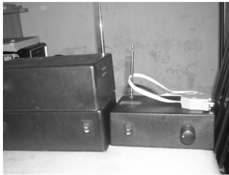
Gambar 17. Pemancar dan penerima pada DTMF sebagai indikator kondisi infus.
