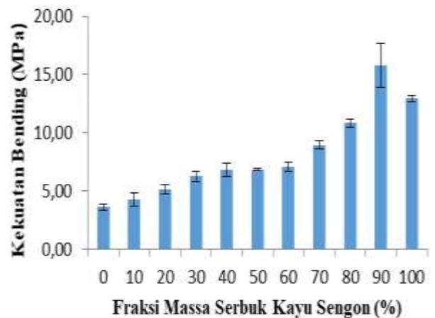
**Gambar 7.** Kekuatan *bending* dan modulus *bending* material komposit *binderless* hasil sintesis
