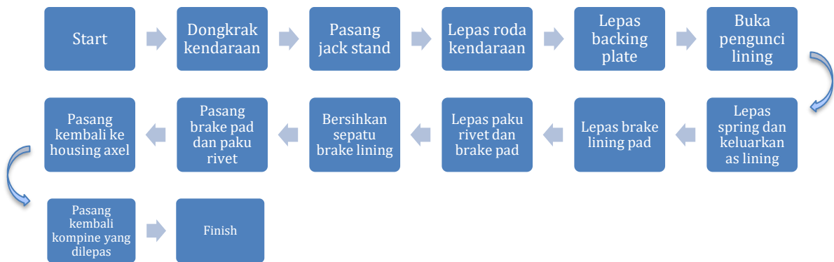
Gambar. 3 Flow chart proses melepas dan memasang paku rivet brake
