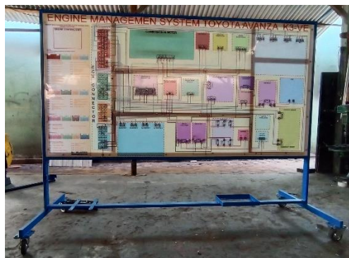
Gambar 3. Panel Board dan Rangka Training Kit sebelum dipasang Komponen-Komponen EMS Toyota Avanza K3-VE
