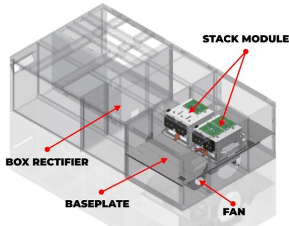
Fig. 1. PWM rectifier box
