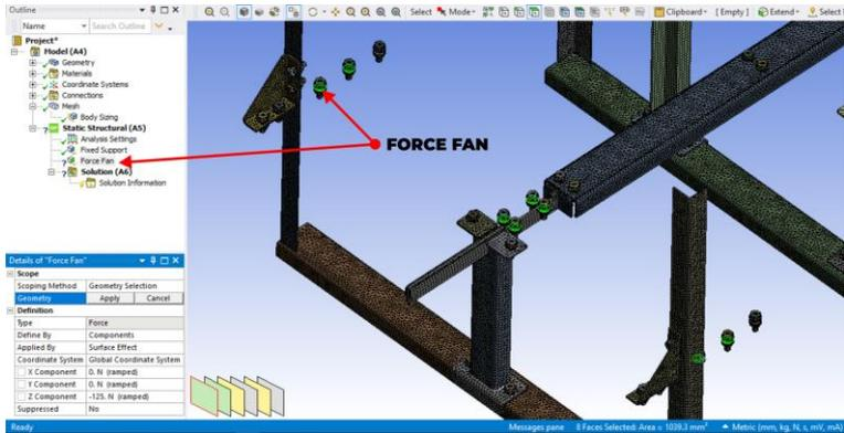
Fig. 5. Force settings for fan load
