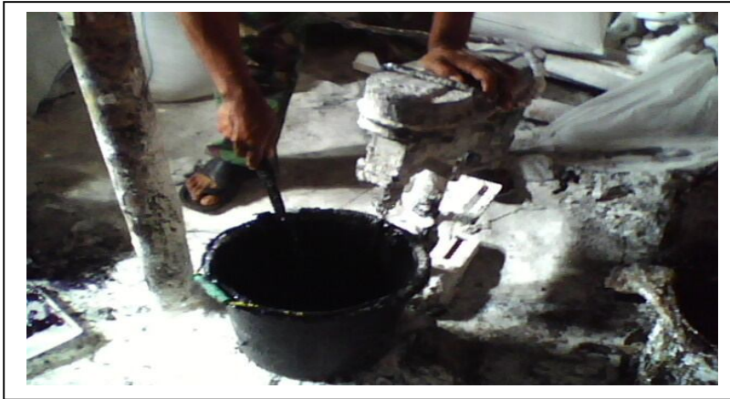
Gambar 2. Pengadukan Adonan Fiberglass dengan Mesin Bor
