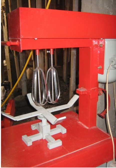
Gambar 4. Realisasi Mesin Pengaduk Fiberglass
