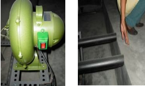
Gambar 8. Posisi Saklar Blower di 1, dan Pemeriksaan Aliran Udara yang Keluar dari Unit Pemanas
