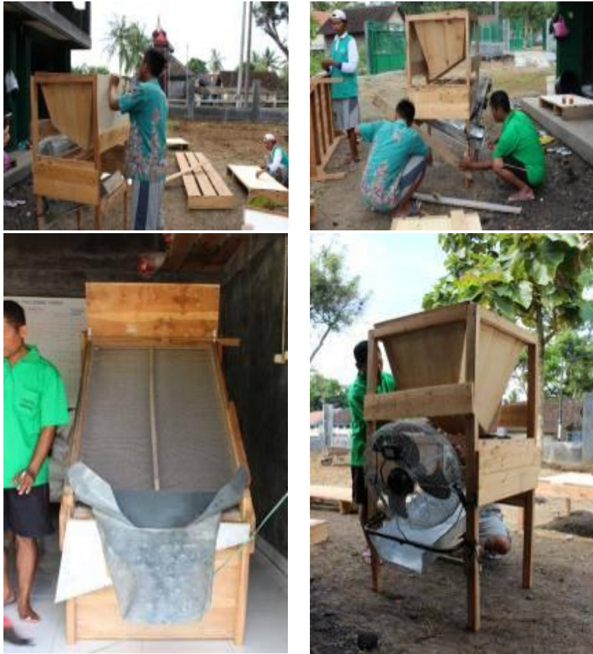
Gambar 3. Pembuatan Alat Grading dan Pemasangan Blower
