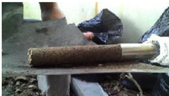
Briket yang telah dihasilkan (Gambar 2) dari mesin *heated die screw extruder* selanjutnya akan diuji impact, yaitu dijatuhkan dari ketinggian 2 meter di atas lantai beton. Kemudian massa briket tersisa ditimbang dan dilanjutkan dengan dijatuhkan lagi dari ketinggian 2 m. Data hasil pengujian disajikan dalam grafik dan dianalisis untuk menentukan temperatur dan putaran mesin yang sesuai untuk proses pembriketan.
