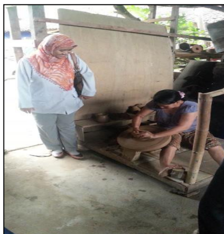
Gambar 1. Alat Putar Miring Pembuat Gerabah Khas Dusun Pagerjuran Klaten
