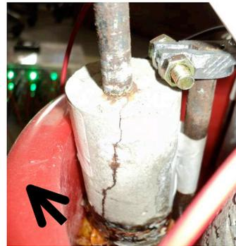
Gambar 11. Pola retak spesimen 1,25" (b)
