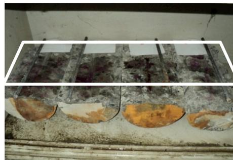
Gambar 19. Karbonasi betonspesimen 6"
