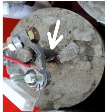
Gambar13. Retak spesimen 3" semakin lebar
