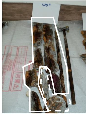
Gambar 15. Karbonasi beton spesimen 1,25" (b)
