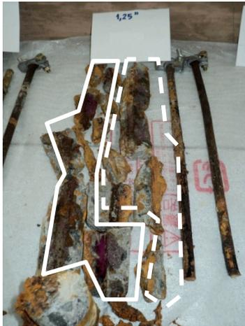
Gambar 14. Karbonasi beton spesimen 1,25" (a)
