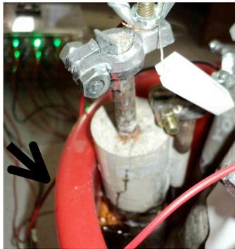
Gambar 10. Pola retak spesimen 1,25" (a)
