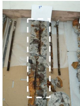
Gambar 17. Karbonasi beton spesimen 3" (b)
