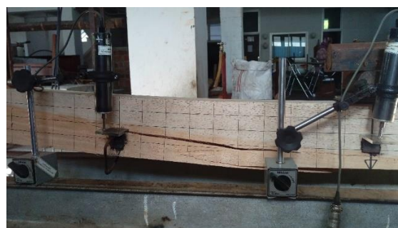
Gambar 6. Pola kerusakan balok sengon utuh
