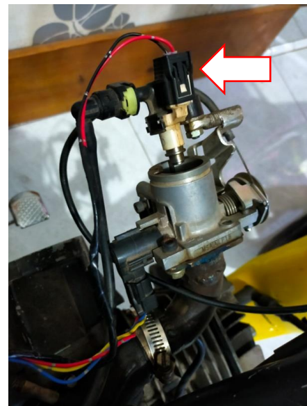
Gambar 9. Pemasangan Soket pada Injektor
