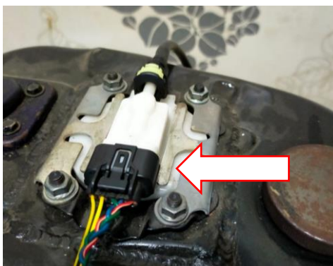
Gambar 7. Pemasangan Soket pada fuel pump
