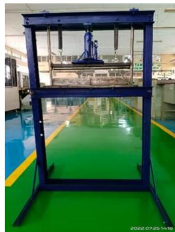
Gambar 11. Alat penekuk pelat untuk celah bentuk U
