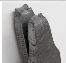
Gambar 9. Patahan Spesimen Uji Tarik Arus 150 A
