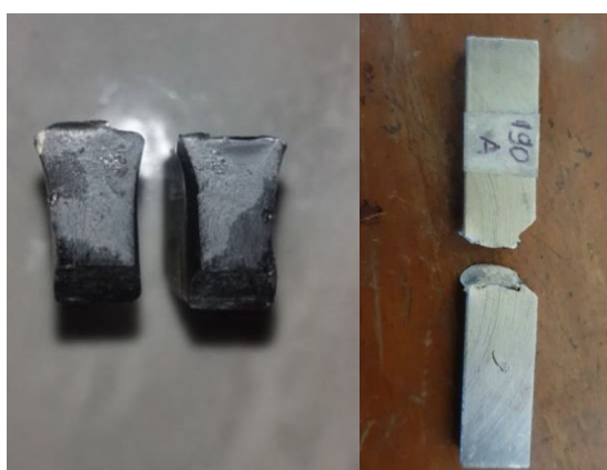
Gambar 15. Patahan Spesimen Uji Impak Arus 190 A
