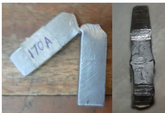
Gambar 14. Patahan Spesimen Uji Impak Arus 170 A
